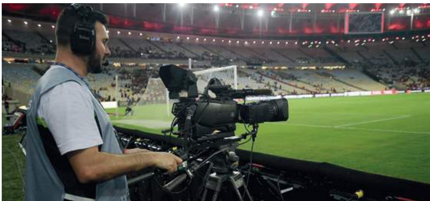
Câmera baixa atrás do gol à Direita (9): Uma câmera em tripé, ao nível do campo, fixa atrás do gol, do lado direito da câmera 1. Em diagonal à câmera 4 que se encontra no outro gol.
